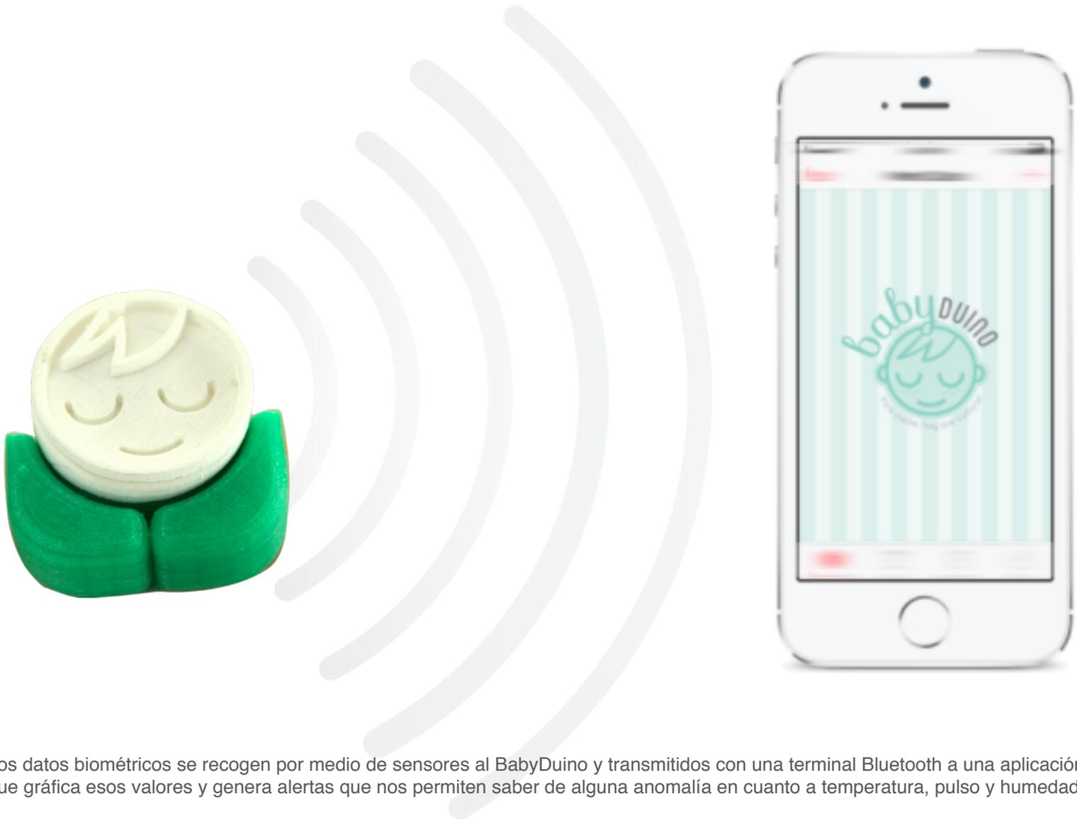
Los datos biométricos se recogen por medio de sensores al BabyDuino y transmitidos con una terminal Bluetooth a una aplicación que gráfica esos valores y genera alertas que nos permiten saber de alguna anomalía en cuanto a temperatura, pulso y humedad de un bebé
